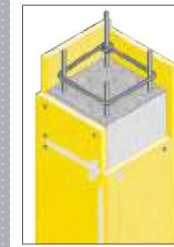
1 - Protezione di strutture in cemento armato
